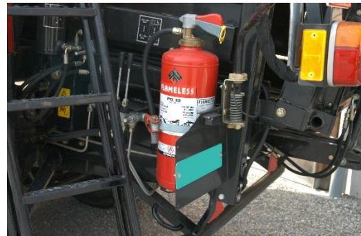
Des moyens d'extinction doivent être présents sur la machine en quantité suffisante. (Photo : SPAA)
