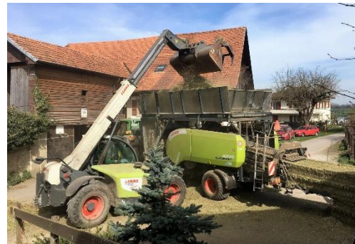
Principe de base : réaliser les travaux de pressage à l'extérieur des bâtiments. (Photo : Bourguet Mécanique SA)
