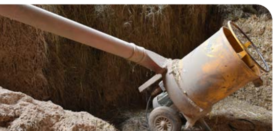
La présence de corps étrangers, tels que des cailloux, dans le broyeur à paille peut provoquer des étincelles. (Image : SPAA)
