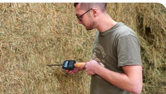
Les sondes manuelles courtes permettent de surveiller l'évolution de la température dans les balles. (Image : CIPI)
