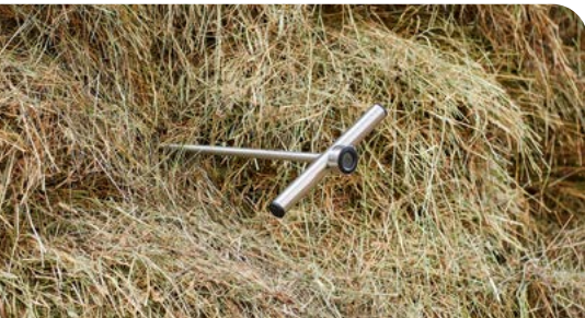
Mesure de la température à cœur du fagot de foin. (Image : CIPI)
